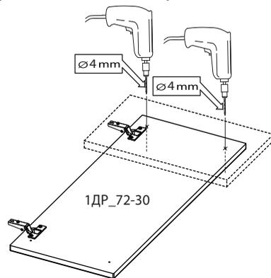
В большинстве моделей кухонь ДВЕРИ РАСПАШНЫЕ (ДР) являются универсальными. При этом перед установкой необходимо определить желаемое направление открывания двери и в зависимости от этого досверлить уже имеющиеся на ней глухие отверстия под ручку на твердой поверхности, во избежание вырывания передней пласти двери.
