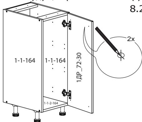
8.2 Снять дверь, досверлить уже имеющиеся отмеченные отверстия насквозь на твердой поверхности, во избежание вырывания передней пласти двери.
