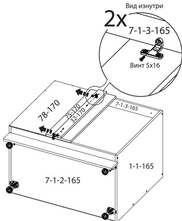
Передняя стенка опоры 6-4-165 крепится к передней стенке опоры приставного шкафа.
