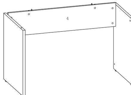
9. Соединить детали № 2 с деталями № 4 и закрутить эксцентрики по часовой стрелке.
