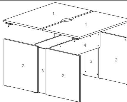
11. Соединить детали № 2 и № 4 с деталями № 1 и закрутить эксцентрики по часовой стрелке.
