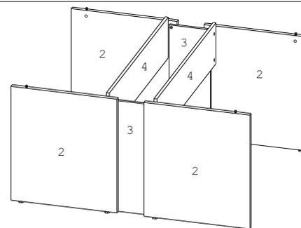
10. Соединить детали № 2 с деталями № 3 винтами L при помощи шестигранника.
