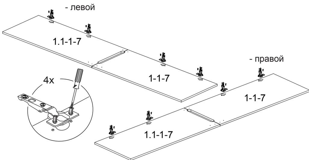
Для сборки шкафа, необходимо досверлить уже имеющиеся отверстия в стенке горизонтальной (2 пары отверстий). Сверлить необходимо на твердой поверхности, которую можно повредить, во избежание вырывания передней пласти детали.
