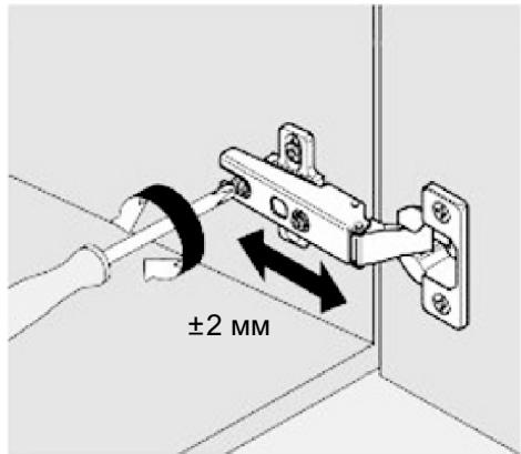
Отпустить винт ответной планки и произвести регулировку промежутка между дверью и корпусом. После этого винт снова затянуть
