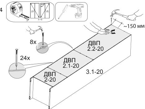
5 Установка передней стенки опоры 5-3 (идёт в комплекте набора)
