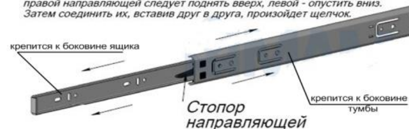
Рис.3 Схема установки шариковых направляющих
