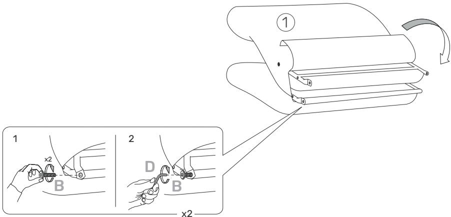
! Дорогие покупатели! Очень важно сначала наживить винт вручную и сделать пару оборотов, чтобы он правильно встал, и только потом затягивать шестигранником!
